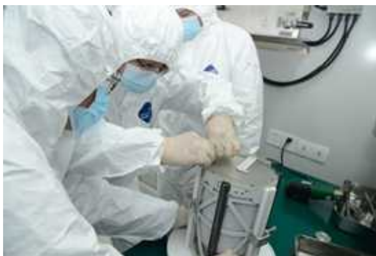
12月20日18:30开始拆解密封封装装置 盖体防尘罩和悬臂支架螺钉拆除
