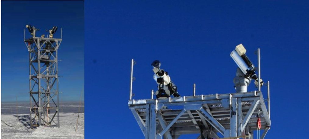
图 2. 南极昆仑站 2 台冗余的视宁度望远镜及其 8 米高的塔架
